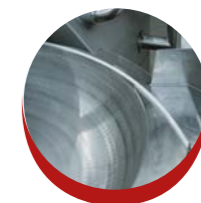
Joint d'étanchéité entre la cuve et la tête retirable pour le nettoyage Air seal between bowl and head removable for cleaning
