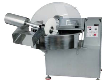
Vide cuve en position de vidage
